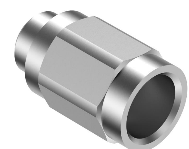
Abb. 23.3 Adapter für Überwachungssensor JPQ1 M10x1 - M12x1 SW14 L25 (Art. Nr.: 3050103160)
