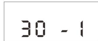
Abb. 24.4 Einstellung 1 P Pausenzeit „Minuten“
