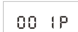
Abb. 24.3 Einstellung 1 P Pausenzeit „Stunden“
