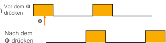
Abb. 25.5 Schmierzeit ändert sich durch drücken der Ⓜ Taste während der Schmierzeit
