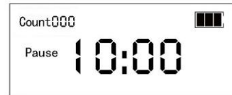
Abb. 24.2 Pausenzeit Display nach erstem Anschluss an Spannung
