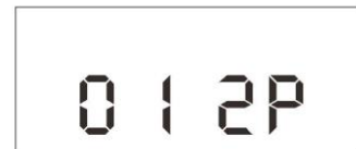
Abb. 24.5 Einstellung 2P Verteilerüberwachung Zyklen
