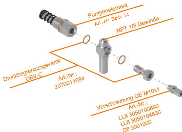
Abb. 16.2 Explosionszeichnung PE mit gerader Verschraubung
