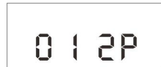
Abb. 23.5 Einstellung 2P Verteilerüberwachung Zyklen
