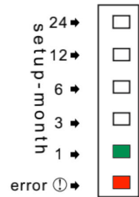
Abb. 9.1 Kein Motorimpuls erkannt (Batterie fast leer)
