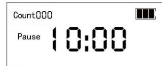
Abb. 23.2 Pausenzeit Display nach erstem Anschluss an Spannung
