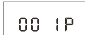
Abb. 23.3 Einstellung 1P Pausenzeit „Stunden“
