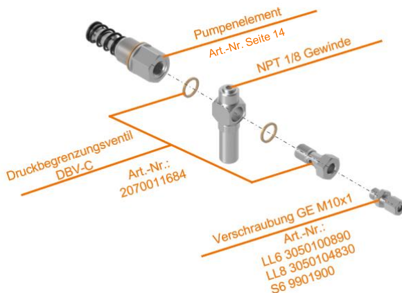
Abb. 16.2 Explosionszeichnung PE mit gerader Verschraubung
