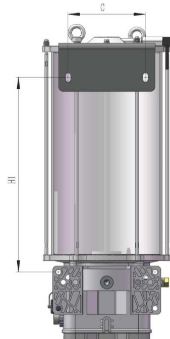
Abb. 19.3 Bei den Behältergrößen 15L u. 20L sind diese Pumpen auch am oberen Halter des Deckels zu befestigen!
