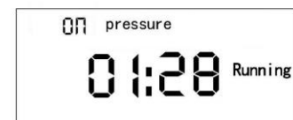
Abb. 24.3 Display für Schmierzeit 3P zählt aufwärts
