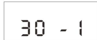
Abb. 23.4 Einstellung 1P Pausenzeit „Minuten“
