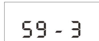
Abb. 23.7 Einstellung 3P - Schmierzeit „Sekunden“
