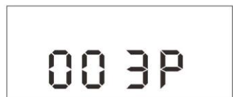
Abb. 23.6 Einstellung 3P Schmierzeit „Minuten“
